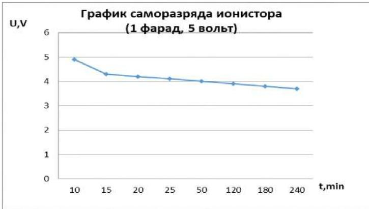
Рисунок 7 – График саморазряда ионистора
