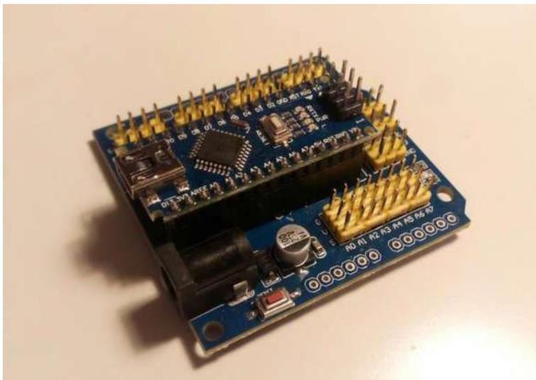
Рисунок 1 – Shield – плата для Arduino
