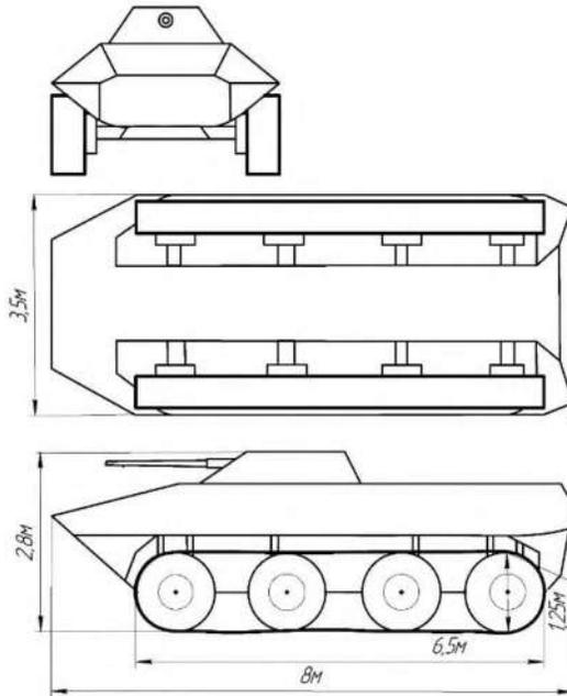
Рисунок 6 - Эскиз колесно-гусеничной машины с электрическими колесами-моторами
