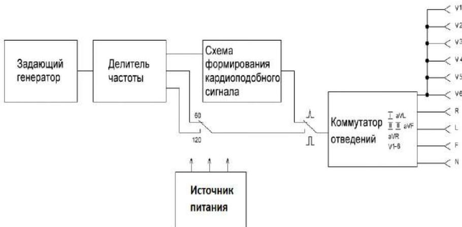
Рисунок 3 – Структурная схема прибора для проверки работы кардиографа
