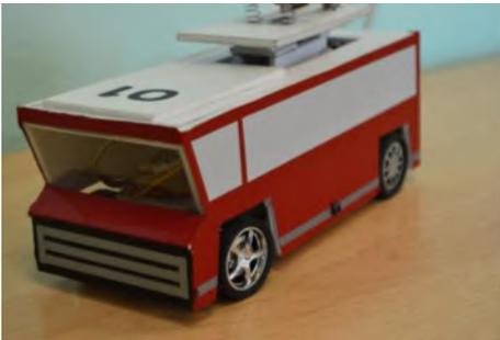
Рисунок 11 – Общий вид электрического автомобиля с пантографом
