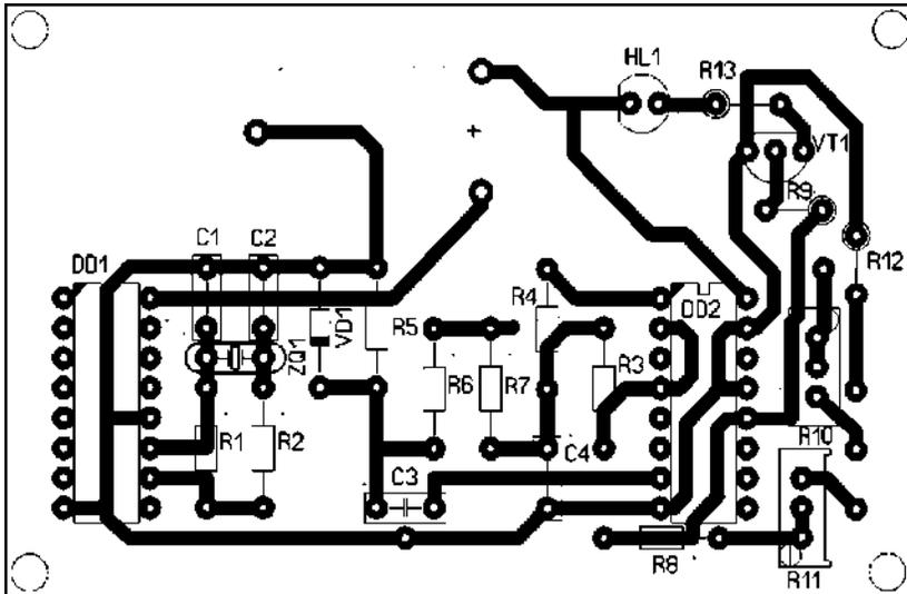
Рисунок 5 – Печатная плата прибора для проверки работы кардиографа
