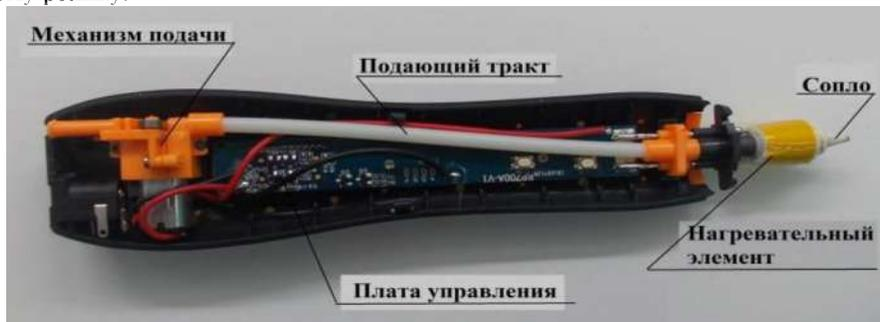
Рисунок 1 – Устройство 3D ручки «Rovermate 3D art»
