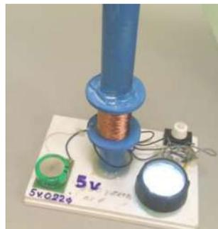
Рисунок 5 – Зарядка ионистора от линейного генератора
