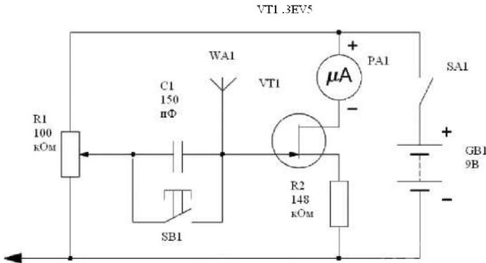
Рисунок 2 – Схема электрометра
