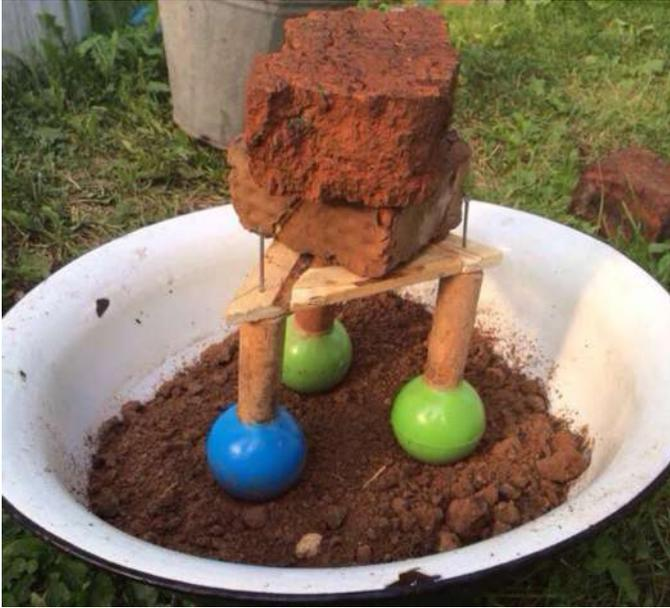
Рисунок 3. Погружение в грунт ступни в виде шара
