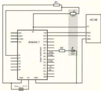
Рисунок 8 – Схема корректора осанки на основе Arduino NANO
