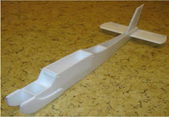
Рисунок 3 – Изготовление киля и руля высоты. Фото автора.
