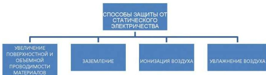
Рисунок 1 – Способы защиты приборов от опасных воздействий заряда
