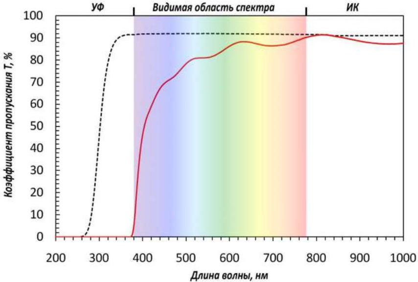
Рисунок 4 – Спектр оптического пропускания пленки ZnO (красная линия), полученной на стеклянной подложке Coming 2947 (черная штриховая линия) при окислении слоя Zn на воздухе при  $T = 450^{\circ}\text{C}$
