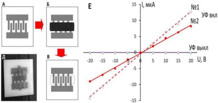
Рисунок 5 – Схема создания макета фоторезисторного датчика
