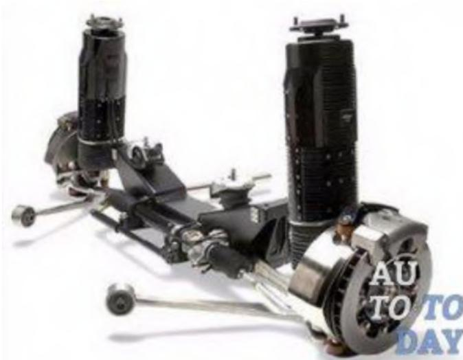
Рисунок 4 – Электромагнитная подвеска
