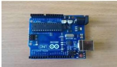
Рисунок 5 – Программируемая плата Arduino
