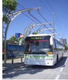
Рисунок 13 – Суперконденсаторные автобусы в г. Шанхае
