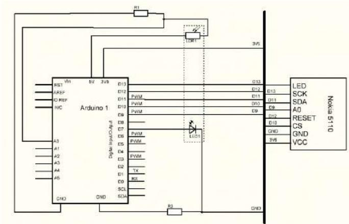
Рисунок 3 – Схема корректора осанки на основе Arduino UNO
