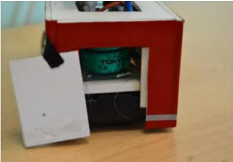
Рисунок 9 – Электрический автомобиль с ионистором
