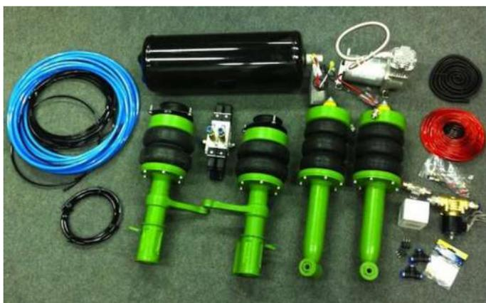
Рисунок 2 – Пневматическая подвеска
