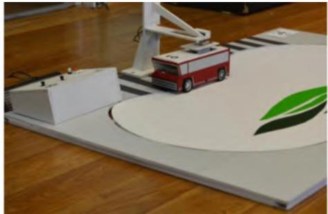
Рис.12. Общий вид модели электрического автомобиля на ионисторах. Подзарядка электрического автомобиля на автобусной остановке
