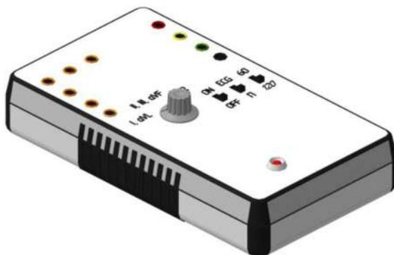
Рисунок 2 – 3D модель прибора для проверки работы кардиографа
