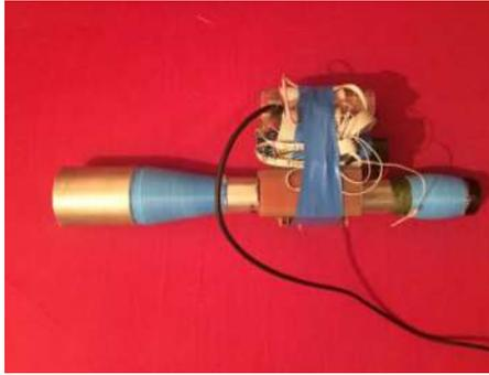
Рисунок 6 – Созданный прицел с вычислительным блоком
